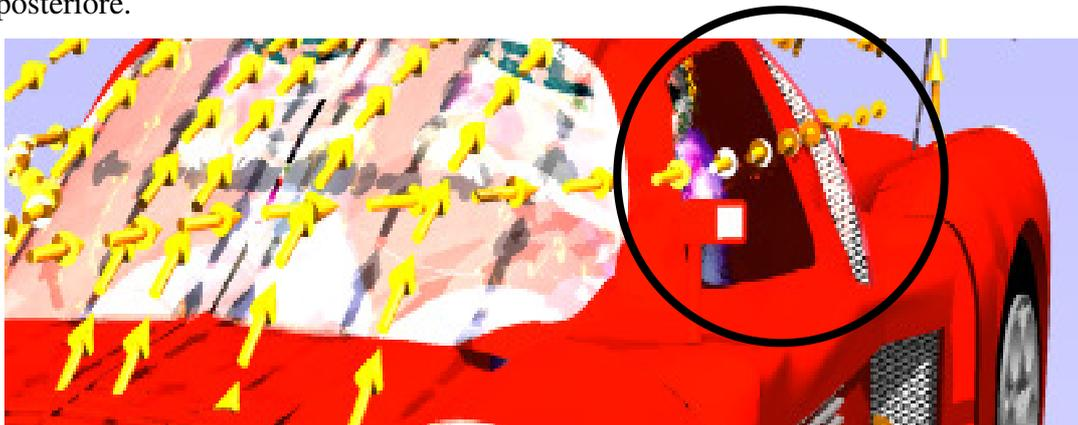
La loro estensione sul fianco serve a sopperire l'assenza dell'airbox e a garantire che il flusso d'aria di raffreddamento venga inviato al motore e fatto uscire dalla griglia di sfogo presente sul retrotreno. Il completamento dello studio aerodinamico del veicolo ha previsto un diffusore atto a aumentare l'effetto deportante al retrotreno e migliorare lo strato limite del flusso che lambisce il fondo vettura, garantendo nella zona di base un  $C_p$  positivo
